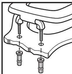
FINGER-TIGHTEN FASTENING NUTS.
